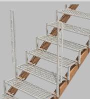
Réaliser le garde-corps de protection latérale avec des planches de bois et la bloquer avec des cales ou des clous.
