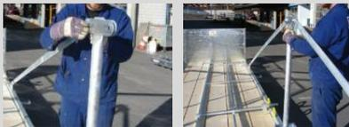
Relever les garde-corps latéraux. Ils se verrouillent automatiquement lorsque la cale descend. Vérifier le verrouillage. 2 personnes sont nécessaires pour cette opération.
