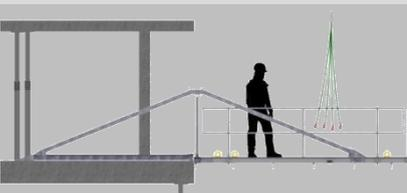
Si des tables de coffrage sont sorties et rentrées, les étais contre la face inférieure de la dalle doivent également être sécurisés avec un boulon d'ancrage DW Ø15 mm.
