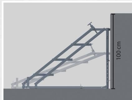
Permet de franchir une différence de hauteur comprise entre 50 et 100 cm (déployable sur 50 à 80 cm)
