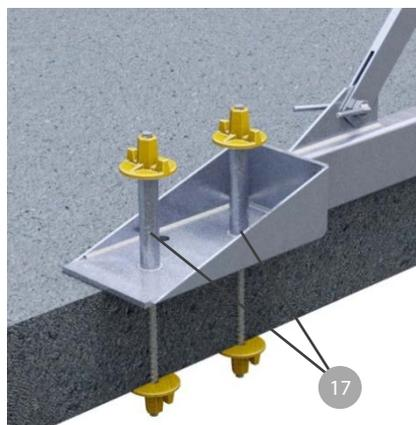
**Variante de fixation 3 avec 1 étau de dalle + et 1 barre DW par longeron porteur**
