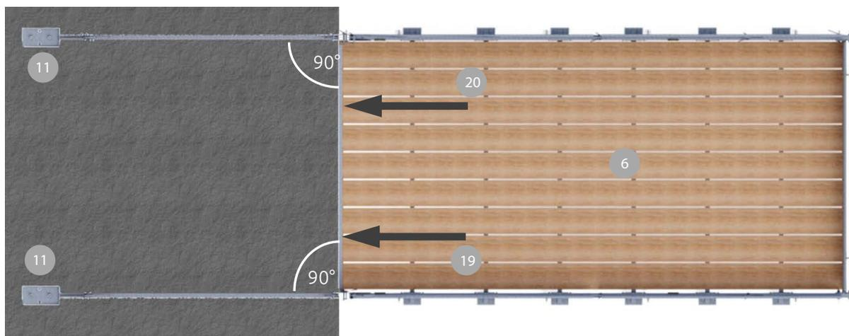
**Variante de fixation 1 avec 2 étais de dalle + fixation par longeron porteur**
