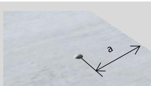
Introduire la cheville à frapper, art. 5608, et l'ancre dans le trou avec un tamponnoir et un marteau.
