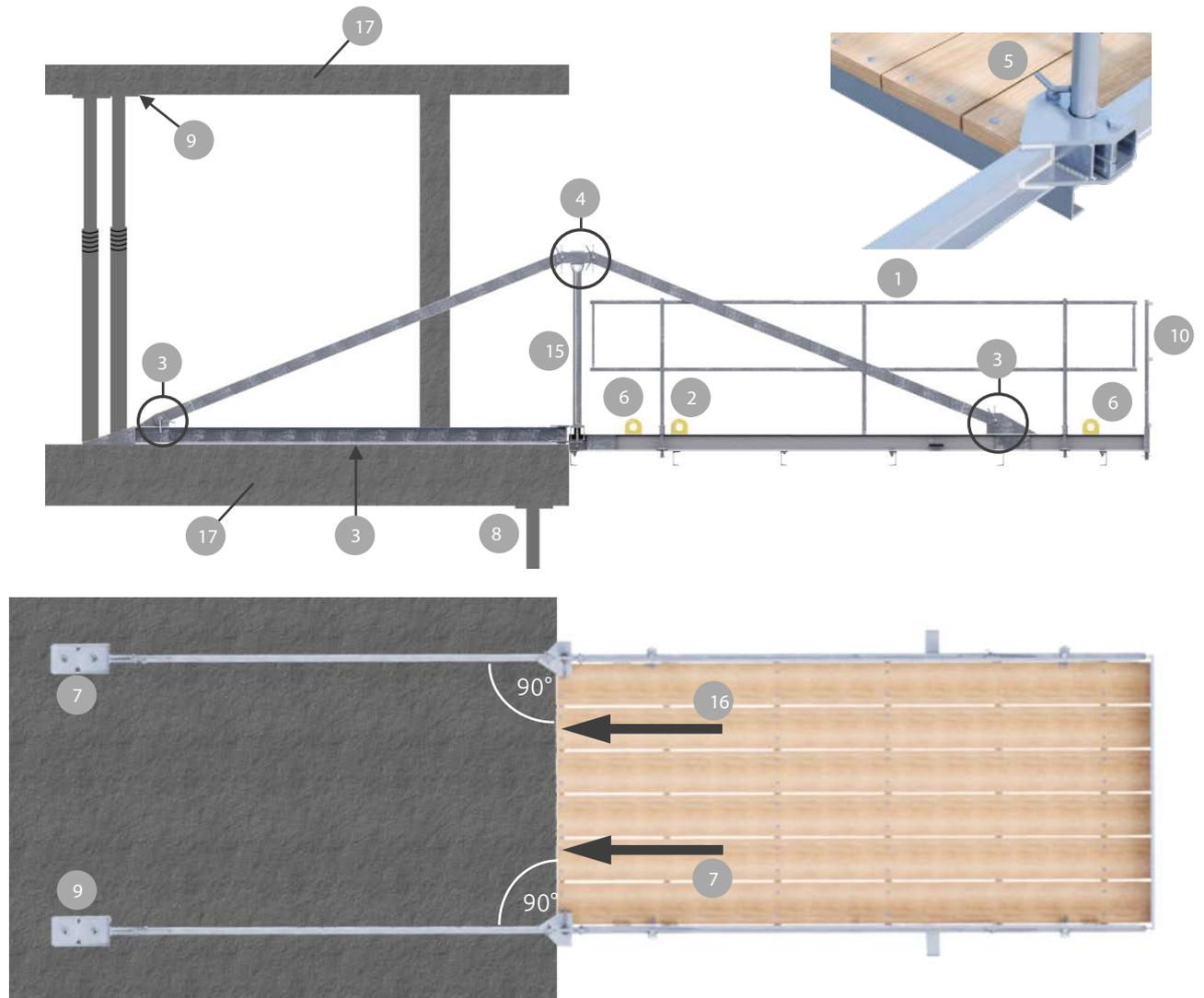
**Variante de fixation 1 avec 2 étais de dalle + fixation par longeron porteur**
